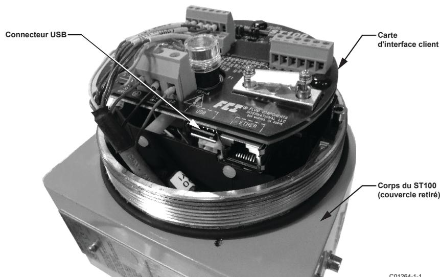
Figure 2 – Connecteur USB sur la carte d'interface client (interface numérique illustrée)
