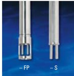
Entscheiden Sie sich für Anwendungen in trockener, sauberer Luft/trockenen, sauberen Gasen mit Mediumtemperaturen von bis zu 454 °C [850 °F] für –FP und –F. Die Designs –FP und –F beinhalten den exklusiven Massengleichheitssensor in Thermoelement-Schutzrohren mit kleinerem Durchmesser für schnellere Ansprechzeiten und eine verbesserte Wiederholbarkeit in Prozessen mit dynamischen Temperaturschwankungen. Das Design –FP beinhaltet zudem einen Sensorschutz.
