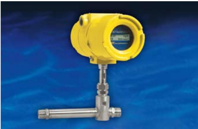
Das Modell ST98L ist ein Inline-Durchflussmessgerät zum Einsatz in den Leitungsdurchmessern DN25, DN40 und DN50 [1, 1 1/2 und 2 Zoll]. Der typische Kalibrierbereich reicht von 0,01 bis 3140 NCMH [0,006 bis 1850 SCFM].<sup>1</sup>
