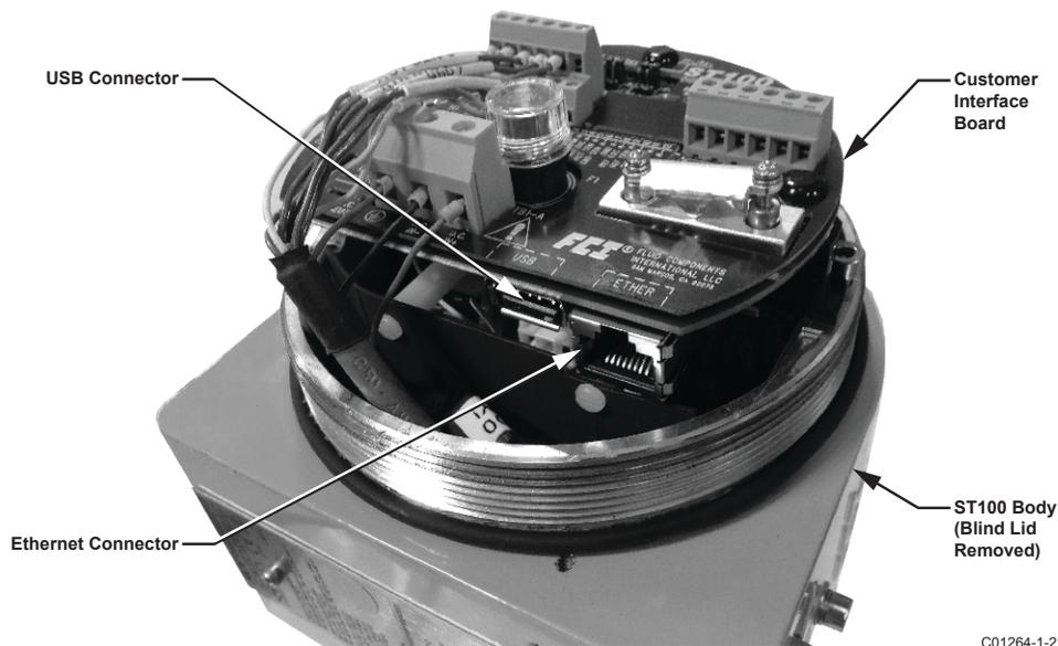
**Figura 1 – Conectores USB e Ethernet da placa da interface de cliente (interface digital mostrada)**
