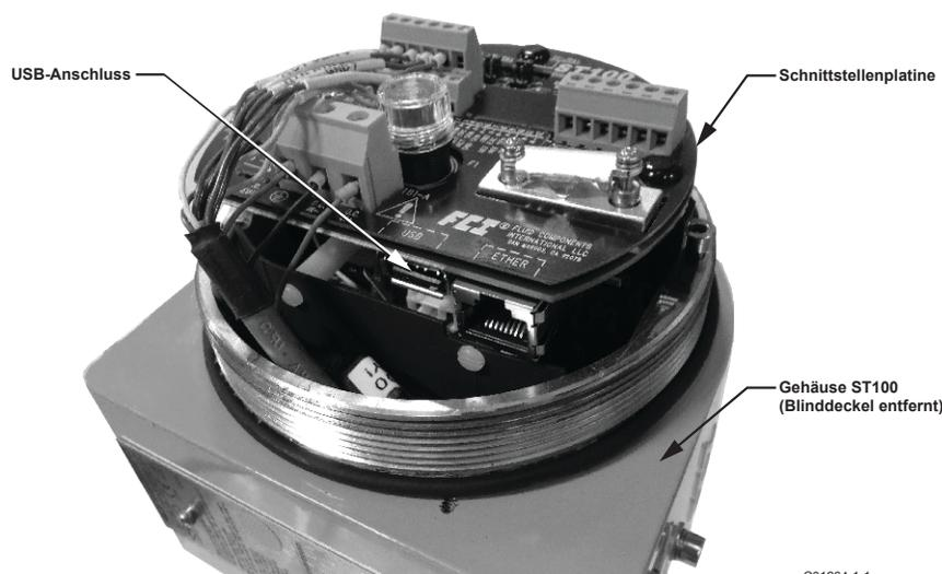
Abbildung 2 – USB-Anschluss auf Benutzerschnittstellenplatte (hier: die digitale Schnittstelle)
