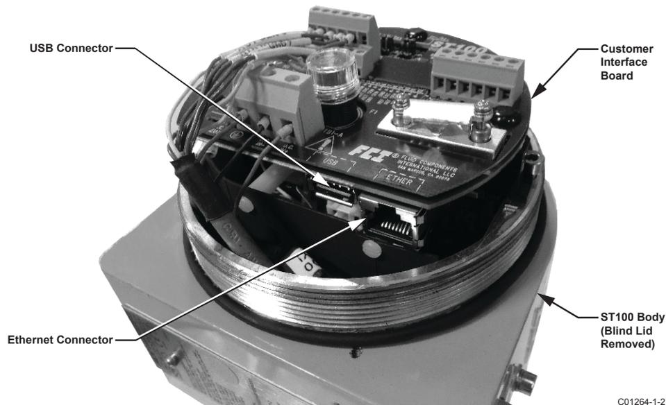
**Figura 1: conectores USB y Ethernet en la tarjeta de interfaz del cliente (se muestra interfaz digital)**
